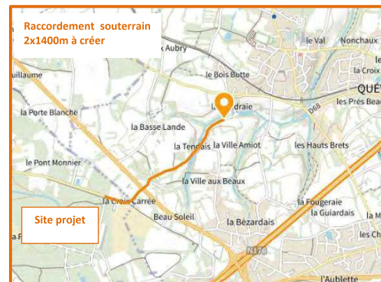
Figure 32 : Tracé prévisionnel de raccordement vers les postes sources de Dinan et de Taden
